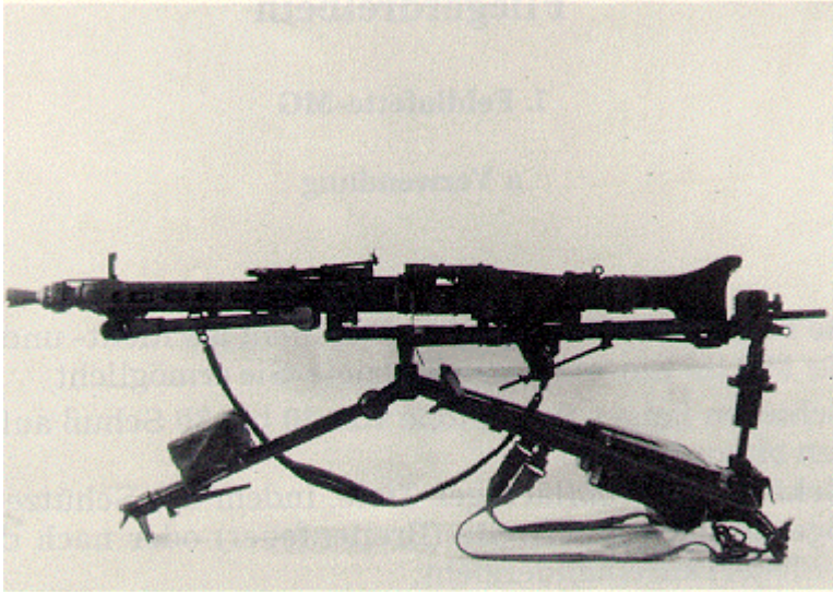
MG auf Feldlafette mit eingeklappten Hinterstützen
