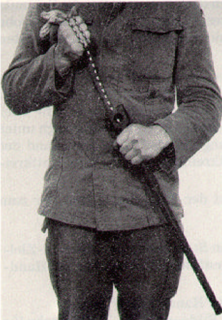
Einführen der Reinigungskette in das Patronenlager
