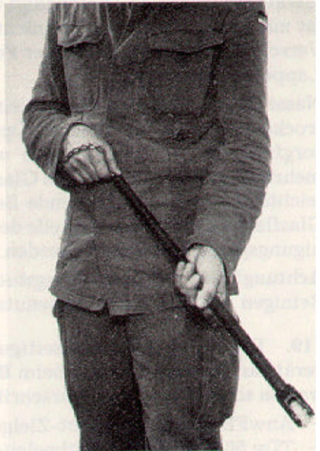
Durchziehen des Rohres mit Reinigungskette und Docht
